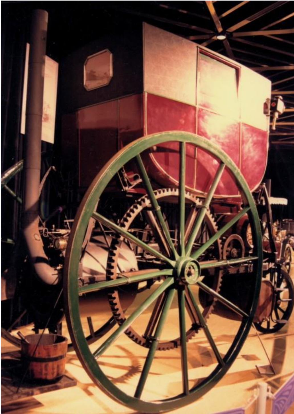
Рисунок 19 – Привод от паровой машины в омнибусе конструкции Тревитика образца 1803 года
